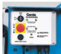
Les commandes de contrôle au sol sont équipées d'un témoin de batteries.
