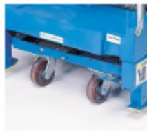
Une pédale permet de relever la structure de base de façon à augmenter la manœuvrabilité.
