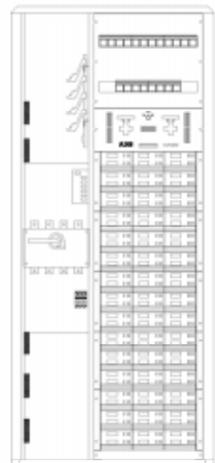
EURODIM 3 avec interrupteur général
